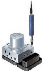
Měření výšky hlavy šroubu
