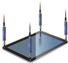
Měření usazení displeje
